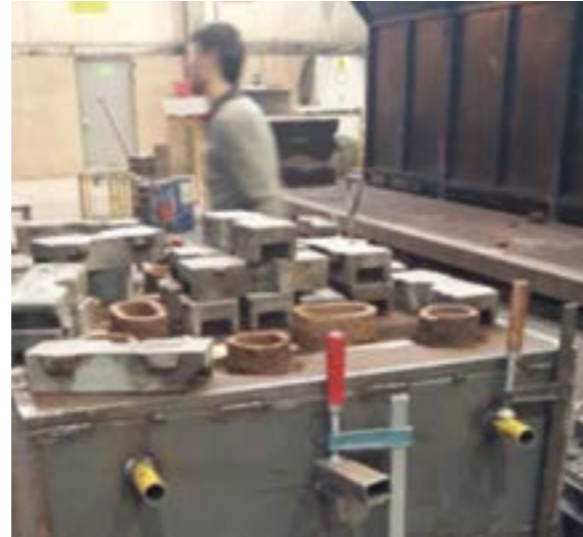
► Şekil 2 Hazırlanan kalıp (a) üstten görünüş besleyiciler, (b) yandan görünüş alt ve üst derece
