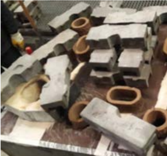
► Şekil 2 Hazırlanan kalıp (a) üstten görünüş besleyiciler, (b) yandan görünüş alt ve üst derece
