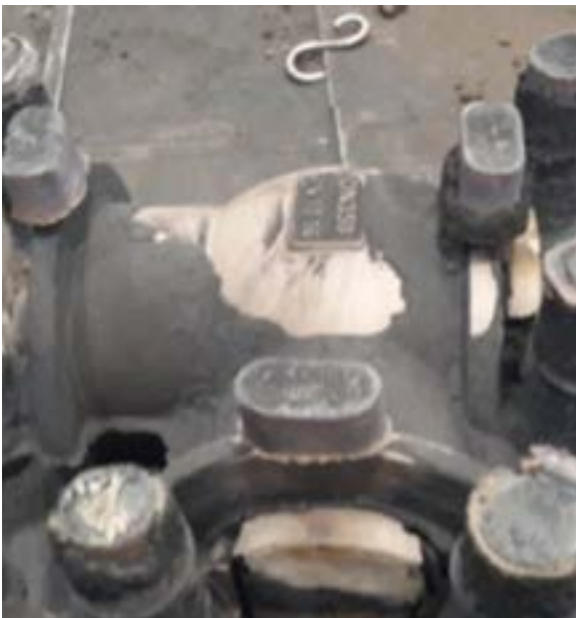
◄ Şekil 3 Kalıp bozulduktan sonra dökülen parçanın salkım görünümü
